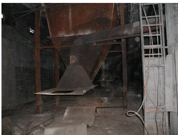
technologie v přístavku - přesyp na pás mostu 6
